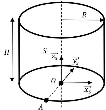
**Question 1: Déterminer les coordonnées du centre de gravité  $G$  du solide  $S$  dans le repère  $(O, \vec{x}_s, \vec{y}_s, \vec{z}_s)$**
